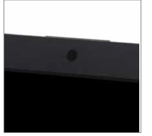
1 megapiksel HD web kamerası
